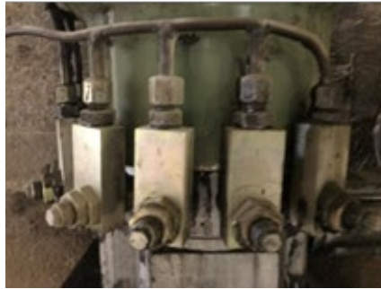
2.kép: Adagoló, egy hajtó kerékre 4 dugattyú dolgozik
