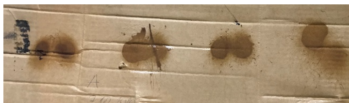
9. Kép: A oldal Szóráskép LE 911 PYROSHIELD
