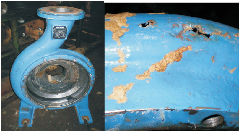
9. ábra: A kopások a már kidobott szivattyúházon
