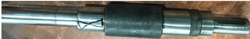
3. ábra. A javítandó tengely
