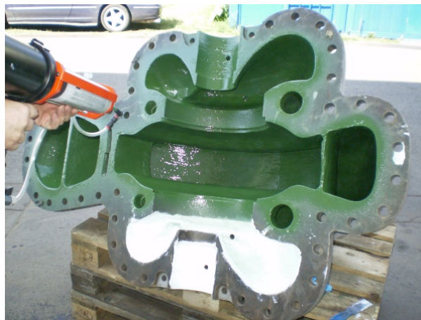
6. ábra: A bevonat felhordása
