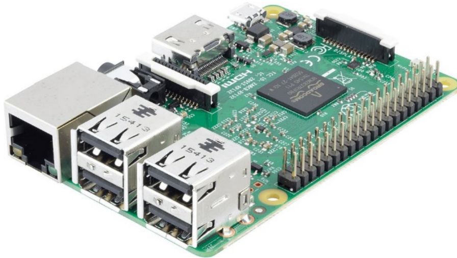
2. ábra: A Raspberry PI, bankkártya méretű számítógép
