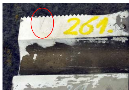
9. ábra: Repedés a kompresszorhoz csatlakozó passzdarab menetes részén
