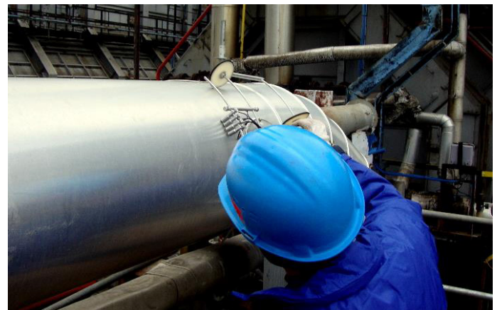
27. ábra: MMM vizsgálat szigetelésen keresztül
