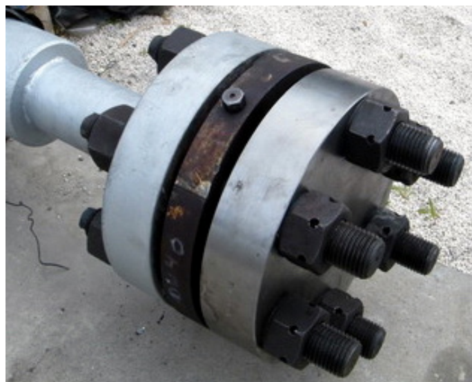
7. ábra: Kötőelemek és lencse összeszerelt állapotban
