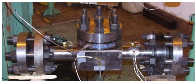
6. ábra: Keverési pont vizsgálat közben a Nagynyomású Szerelvényvizsgáló Állomáson akusztikus emisszióval és nyúlásméréssel kiegészített szilárdsági nyomáspróba
