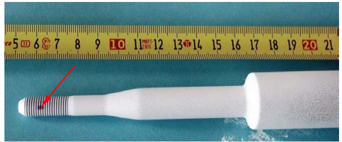
23. ábra: Repedés az olajbefecskendező menetes részén
