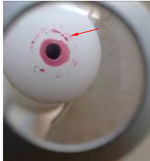
24. ábra: Repedés az olajbefecskendező tömítő felületén
