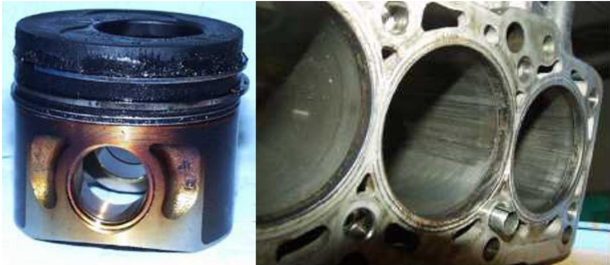
4. ábra: A Volkswagen biodízel kísérletének eredménye: lerakódások és kopás
